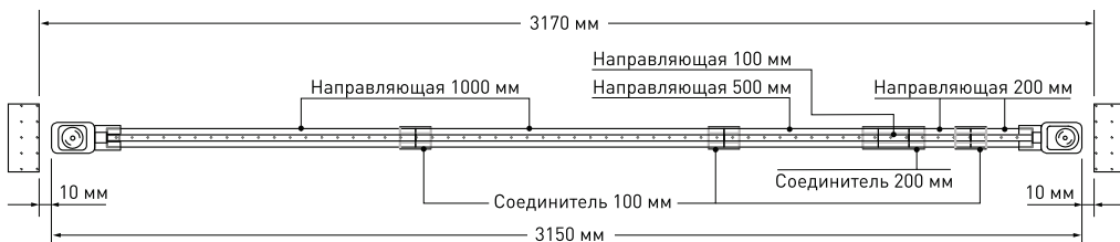
Рис. 3. Пример сборки направляющей длиной 3.15 м
